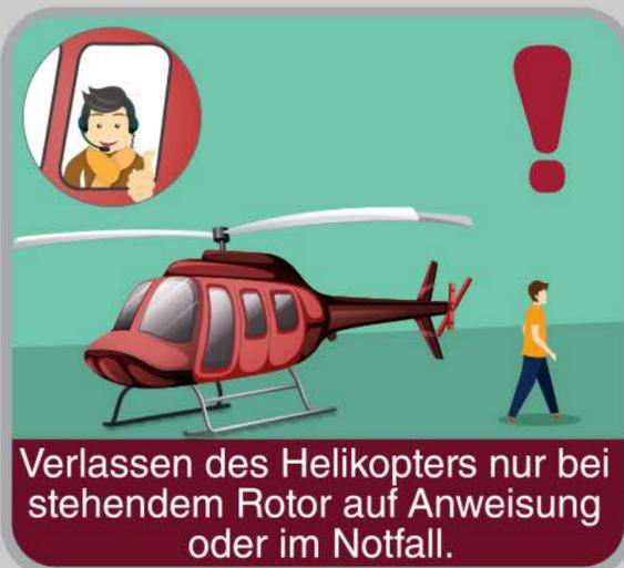
Verlassen des Helikopters nur bei stehendem Rotor auf Anweisung oder im Notfall.
