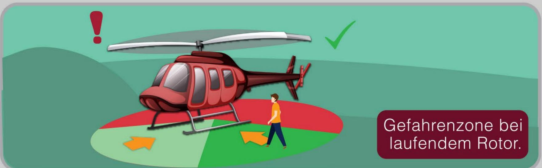
Gefahrenzone bei laufendem Rotor.
